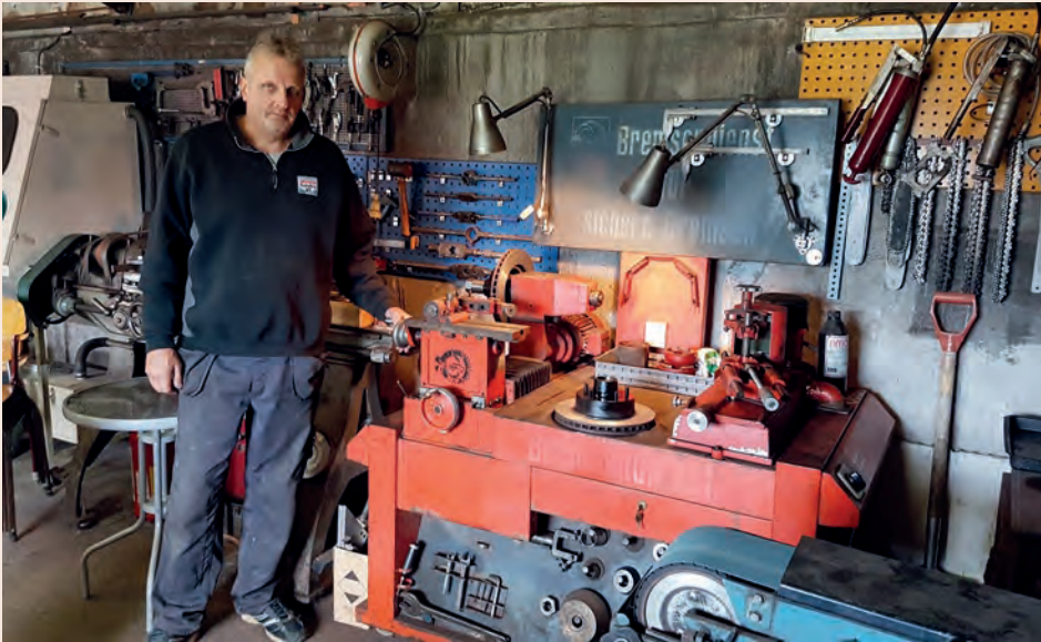
Odd Jakobsen med si spesialmaskin for dreining av bremsetromlar skiver og svinghjul.
